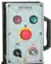
Aparte startknop, aparte stopknop, aparte noodstop, schakelaar koelpomp, potentiometer Vario drive 20-62 m/min
