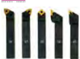
5-delige beitelsset 20 mm met HM wisselplaatjes in Aluminium opbergkoffer met inleg.
