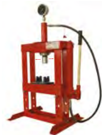
Hydraulische tafelpers met manuele bediening. 10 ton.
