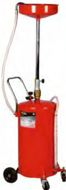
Olieopvangunit met pneumatische lediging.
