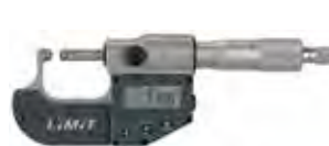
Micrometer met digitale aflezing. DIN 863. Absolute en toenemende meting. Gehard en geslepen. On/off switch. Aflezing 0,001mm - 0,0005". Mm/inch omstelbaar. Met slijpknop en vergrendeling. Geleverd zonder batterijen (batterij 1xSR44).
