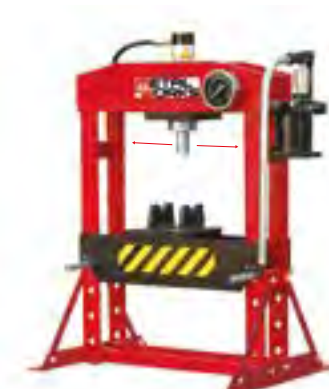
Hydraulische tafelpers met manuele bediening. 15 ton.
