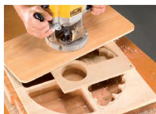
Frees nu de binnenkant uit d.m.v. de sjabloon en de bovenfrees met volglager Terminez la partie intérieure du plateau avec la fraise et le mandrin
