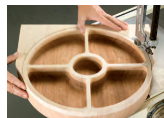
Gebruik een lintzaag voor het wegzagen van het overtollige materiaal Utilisez une scie à ruban pour fraiser l'extérieur du plateau
