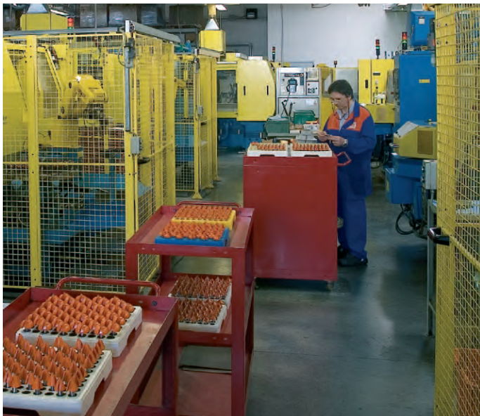
Het laden van de geautomatiseerde meerassige CNC slijpmachines. Affûtage multi-axes CNC robotisé.
