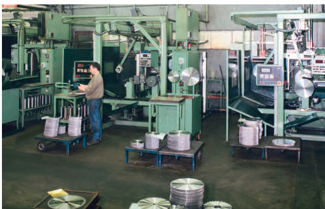
Slijpen en de spanning in het zaagblad uitduwen Rectification et tensionnage automatique.
