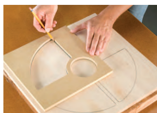
Teken de vorm in de sjabloon. Tracez la forme dans le gabarit.
