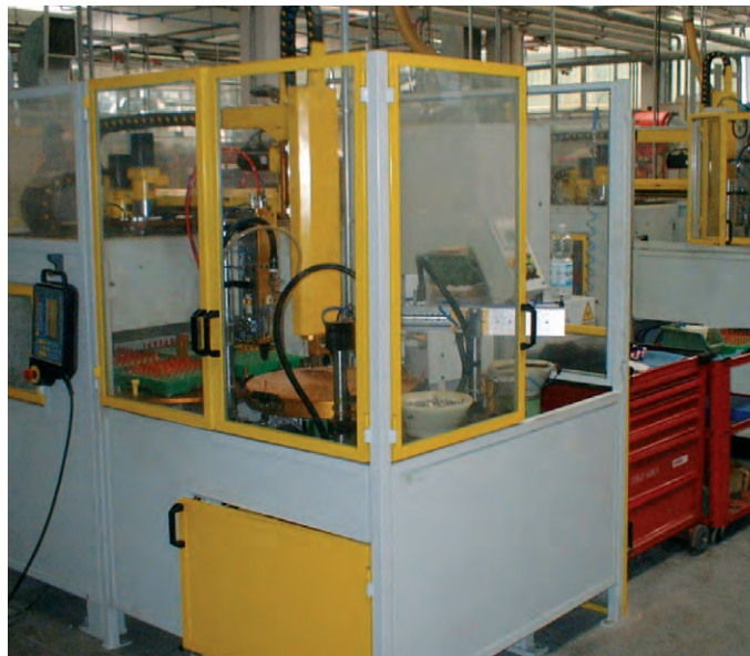
Volledig geautomatiseerd verpakkingssysteem en markeren van de frezen. Assemblage et marquage automatisés.
