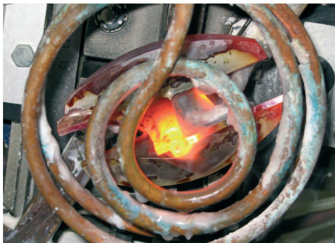
680 ° C in seconden - en het solderen is voltooid. Soudage à 680° en quelques secondes
