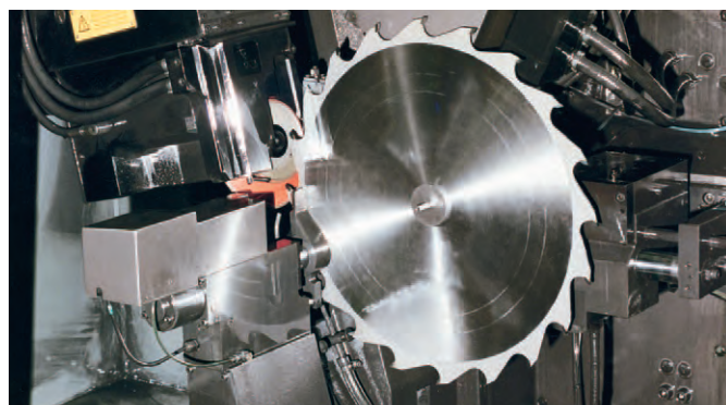
Het slijpen van de carbide tanden Affûtage à CNC robotisé.
