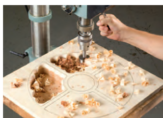
Gebruik een Forstner boor en verwijder zoveel mogelijk materiaal uit je plateau. Utilisez une mèche Forstner de 50,8mm pour enlever le plus de matériau possible du plateau.
